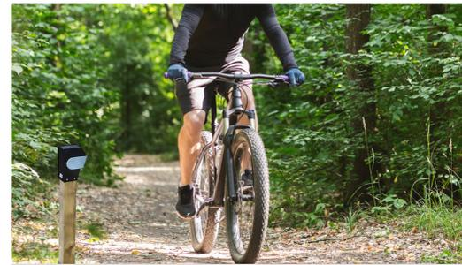
Zählbreite pro Sensor: 1 bis 6 Meter. Ideale Breite: 3 m, um eine Genauigkeit von über 95 % zu gewährleisten. Wenn die Breite mehr als 3 m beträgt, sinkt die Genauigkeit auf 90%.
