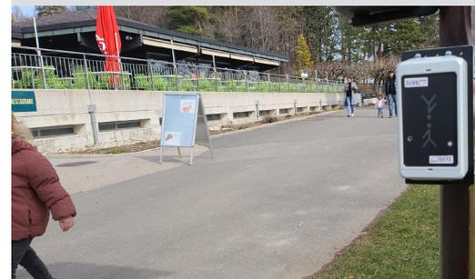
Sofortige Inbetriebnahme - keine elektrischen Anschlüsse, Erkennung der Durchgangsrichtung, einfache oder doppelte Richtung.
