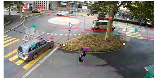
Automatische Erfassung des Verkehrsflusses aller sich bewegender Objekte ohne Speicherung von Video- oder Bilddaten.
