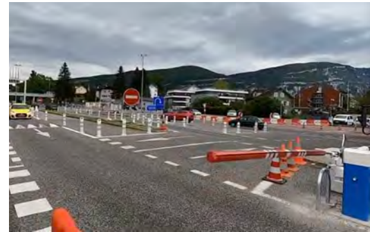
Schranke öffnet automatisch, wenn eine Mindestanzahl an Insassen vorhanden ist.
