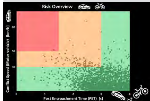
Évaluation des situations dangereuses (quasi-collisions) à l'aide de notre matrice de risque.
