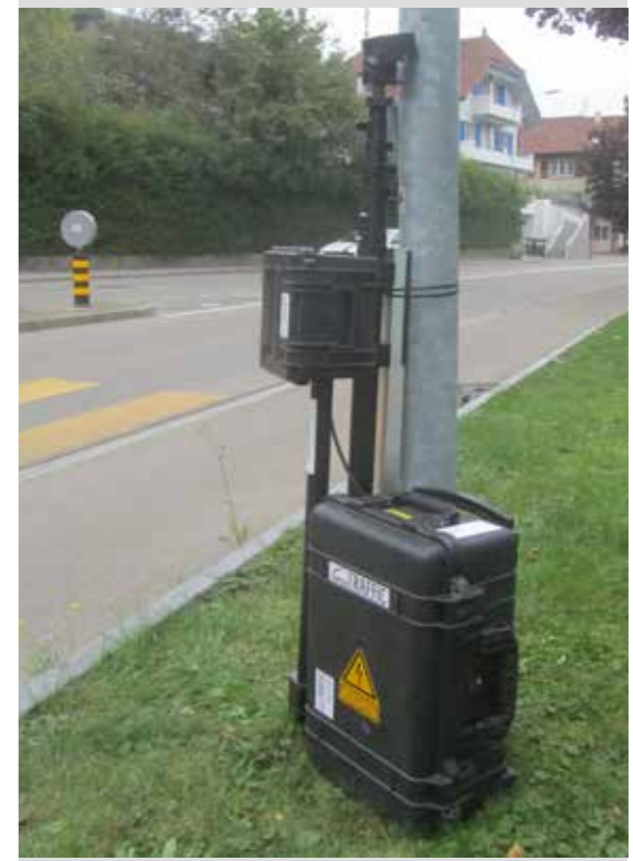
Mobiles Kamerasystem mit integrierter AI-Analysesoftware für Echtzeit-Auswertungen und Darstellung in eigenem Dashboard.
