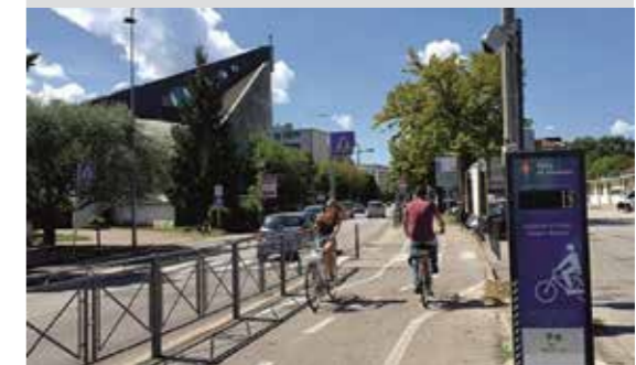
Ein typisches Fahrradzählssystem bestehend aus Laser-Scanner und LED-Display.
