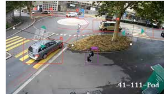
Automatische Erfassung des Verkehrsflusses aller sich bewegender Objekte ohne Speicherung von Video- oder Bilddaten.
